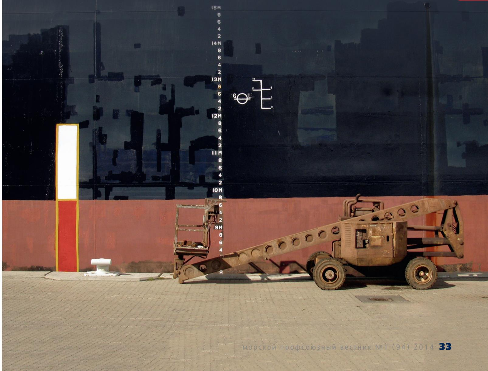
**В наше время такие аварии единичны, нагружать суда сверх допустимого запрещено. Определить степень максимальной загрузки позволяет горизонтальная черта на борту. Она проходит через центр круга, в котором шесть горизонтальных полос указывают допустимую высоту надводного борта для безопасного плавания в разное время года и при различных условиях. Эту линию называют грузовой маркой или линией Плимсоля, но мало кто знает, кем был человек, оставивший память на каждом борту.**
